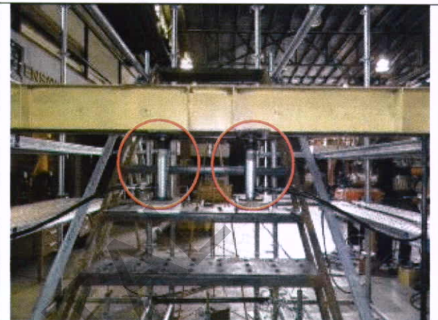
Fotografía 3.1.2: Detalle de los gatos hidráulicos utilizados para efectuar la sollicitación.
